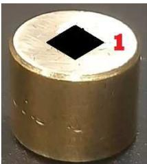
Dependendo da amostra (tipo, característica, etc), pode-se utilizar tinta condutiva de carbono para fixar o material. A aplicação é feita com um pincel ou um palito. Quando fizer uso dessa técnica, esperar secar a tinta. Normalmente, 30 minutos é tempo suficiente para que os solventes evaporem, evitando assim a contaminação da câmara do MEV.
